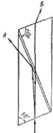
Рис. 24. Устройство поляризатора. А — обыкновенный луч; В — необыкновенный луч
