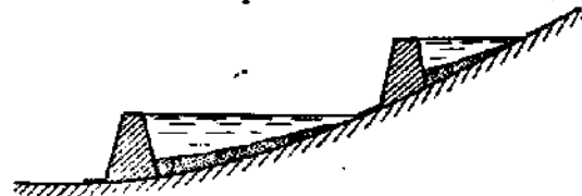
Рис. 115. Схема размещения противоразмывных плотин в овраге
