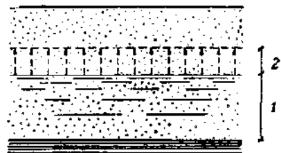
Рис. 136. Капиллярный подъем в грунтах: 1 — грунтовая вода, 2 — зона капиллярного поднятия
